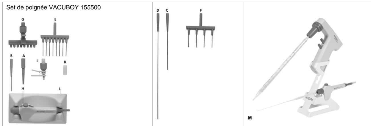
**Poignée VACUBOY** : poignée d'aspiration (H), deux adaptateurs (B et I), adaptateur en caoutchouc pour pipettes Pasteur (K), lubrifiant silicone
